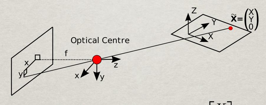
$$\gamma \begin{bmatrix} x \\ y \\ 1 \end{bmatrix} = \mathbf{K} \begin{bmatrix} r_{11} & r_{12} & r_{13} & t_1 \\ r_{21} & r_{22} & r_{23} & t_2 \\ r_{31} & r_{32} & r_{33} & t_3 \end{bmatrix} \begin{bmatrix} X \\ Y \\ Z \\ 1 \end{bmatrix}$$
