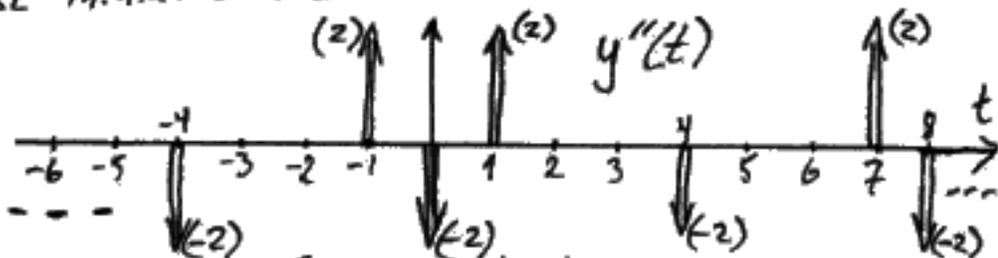
$$y''(t) = \sum_{k=-\infty}^{\infty} C_k'' e^{jk\omega_1 t}, \text{ där } C_k'' = \frac{1}{T} \int_{-4}^4 y''(t) e^{-jk\omega_1 t} dt = \text{Integrera } y'' \text{ över } -4 < t < 4$$
