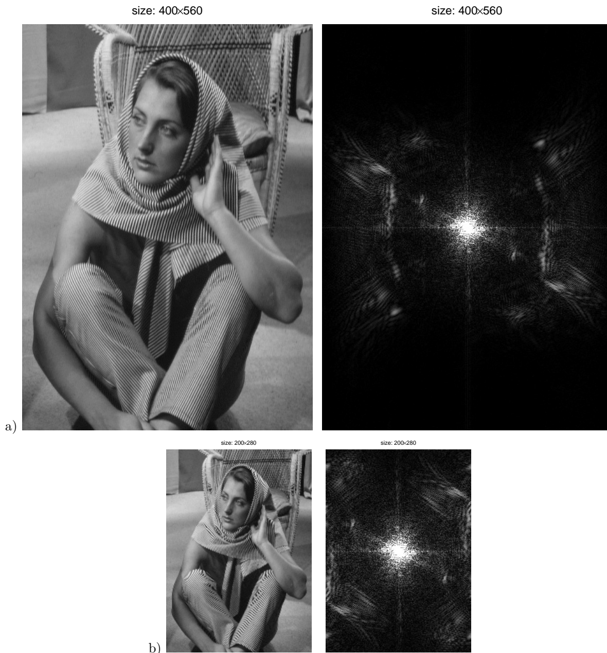
Figur 3.5. Bilder med fouriertransform. a) Tillräcklig samplingsfrekvens. b) För låg samplingsfrekvensen ger vinkningsdistorsion som syns tydligt i bl a byxornas randning. Vinkningsdistorsionen syns även i fourierdomänen som en ökad intensitet för de högre frekvenserna. (Originalbilden finns på http://www.imageprocessingplace.com/ . Ursprungligen från Allen Gersho's lab, University of California, Santa Barbara.)
