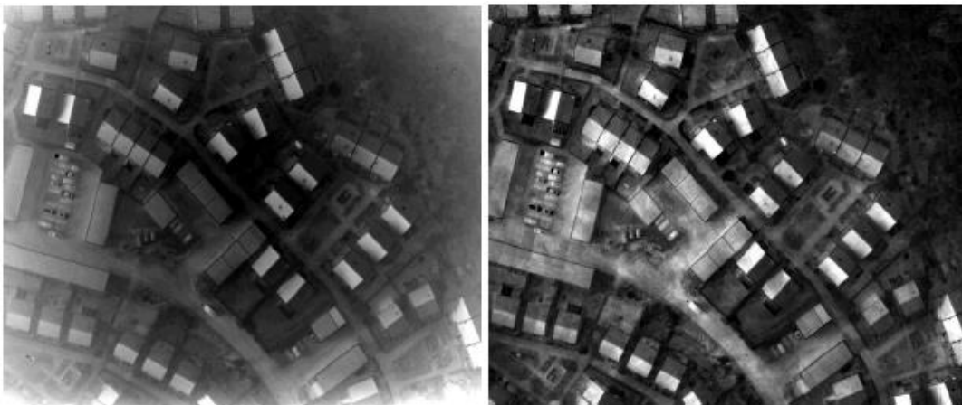
Figur 1: Råbild från termisk IR-kamera (vänster) samt korrigerad bild efter scenbaserad icke-uniformitetskorrektion med hjälp av metoden constant statistics (höger). (T. Lindquist, Nonuniformity correction of digital image data, Lunds Universitet & FOI, 2011).
